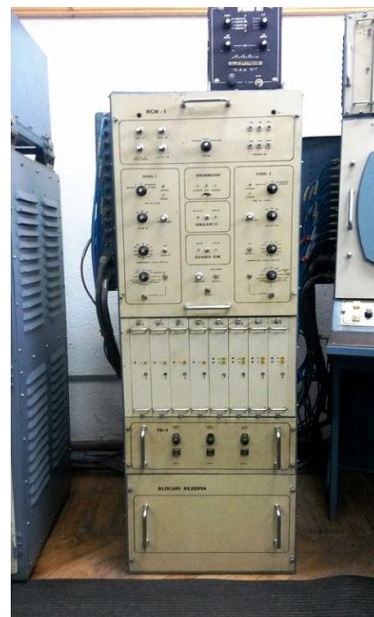
Foto Nr. 17, Instalație INSTM și IPIBAR-M1, pentru radarul START 1, produs de serie (1991)
